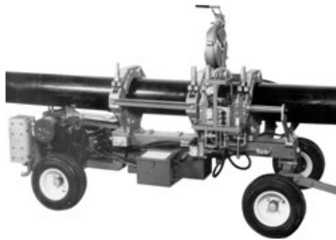
รูปที่ 2.17 เครื่องต่อท่อโดยใช้ความร้อนหลอมละลายท่อให้ติดกัน
