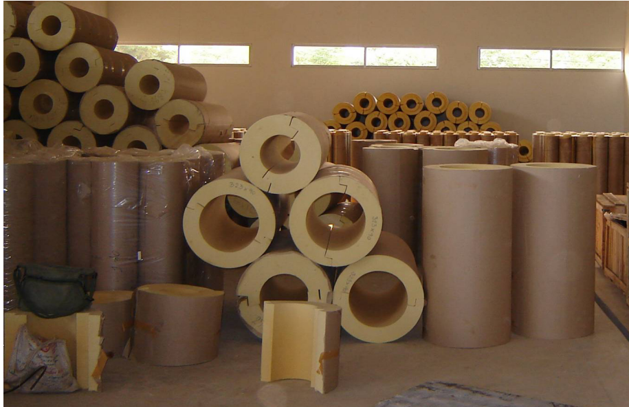
รูปที่ 12.2 ฉนวนทรงกระบอกสำหรับหุ้มท่อ
